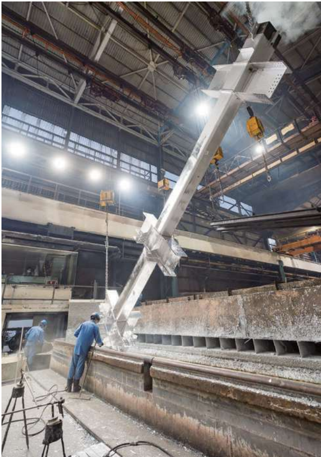
450℃で溶かした亜鉛に製品を浸す
